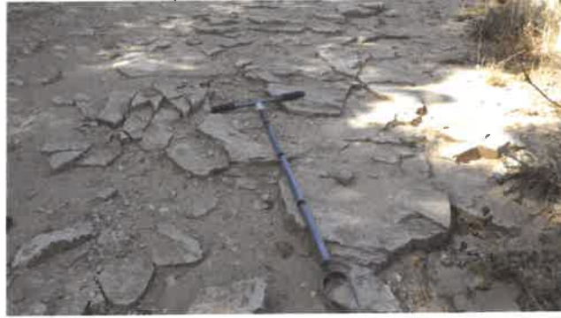
Croute de battance caractéristique d'un horizon superficiel exclusivement limoneux (formation RC)
